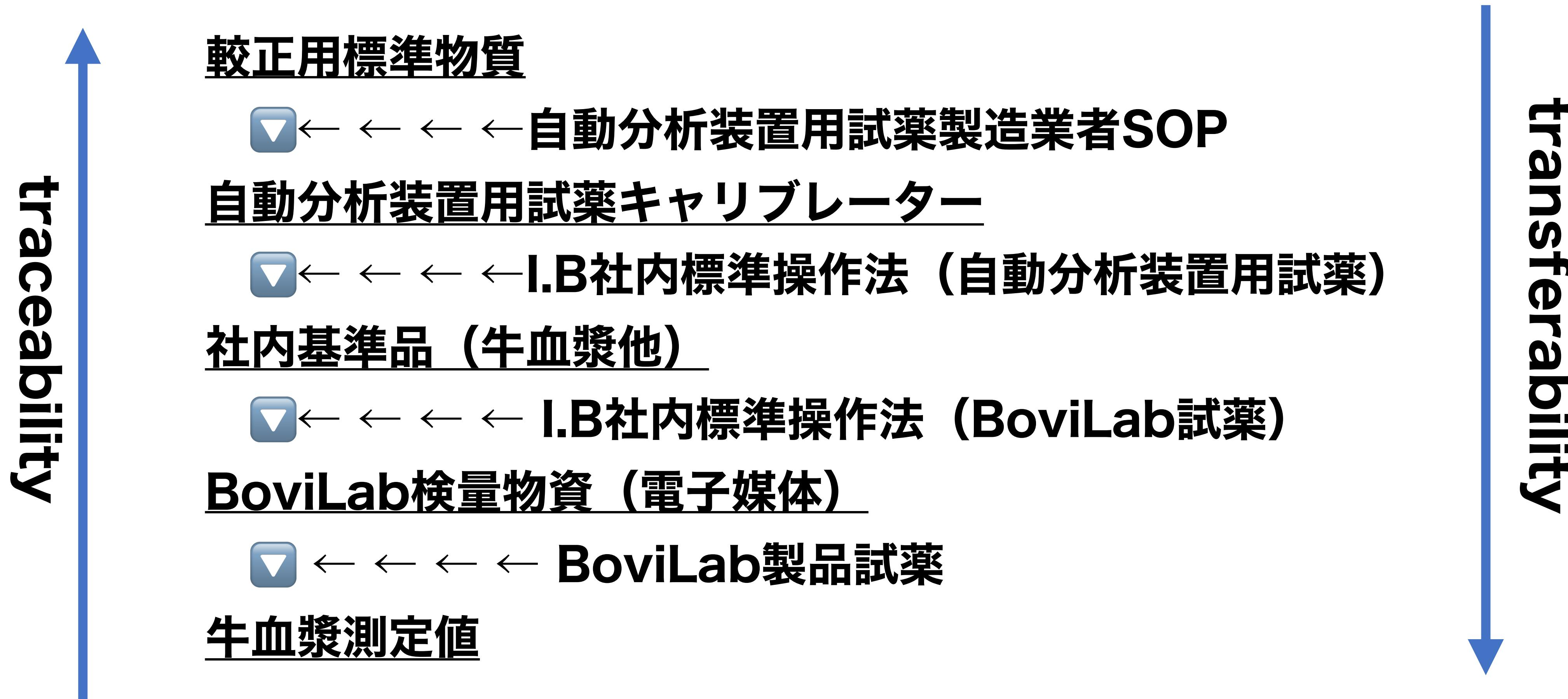
ドライ試薬の性格上、較正用標準物質を直近上位の較正物質として使用できないため、本邦にて標準化されたシステム（e.g. JSCC 標準化対応）にて牛血漿に値付けを実施、その濃度をBoviLab試薬に伝達することにより、較正用標準物質へのtraceabilityを確保しています。
